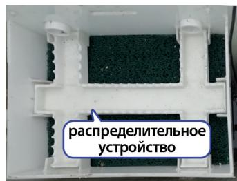
Для промывки фильтра необходимо снять распределительную систему, вынуть наполнитель и промыть каждый слой большим количеством воды.
