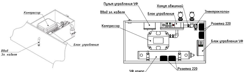
6. После подключения подводящего электрического кабеля в блок управления станции и установки компрессоров производится заполнение водой камер станции до отметок, обозначенных на производстве, а приемная камера наполняется на 50%. Необходимо убедиться в том, что датчики уровня в приемной камере имеют свободный ход и откреплены от стенок камеры
